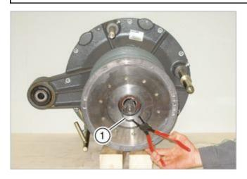
► Insert circlip (1).
